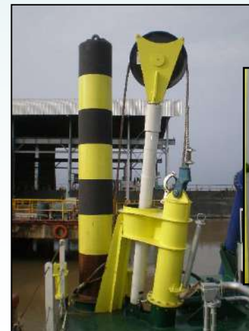
Spud hoisting and spuds
